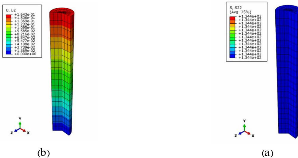
شکل ۱۱. کانتور تنش نرمال در راستای محوری (a) و کانتور جابجایی در راستای محوری (b) برای مدل سه‌بعدی RI \pm Fig. 11. Normal stress contour in the axial direction (a) and displacement contour in the axial direction (b) for the RI \pm model
