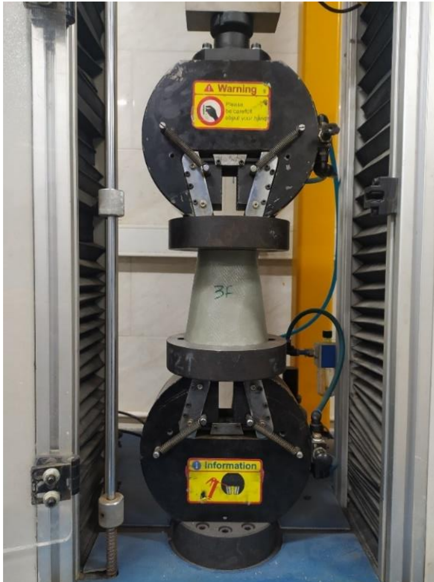
شکل ۵. انجام آزمایش فشار با سرعت ثابت ۲ mm / min
