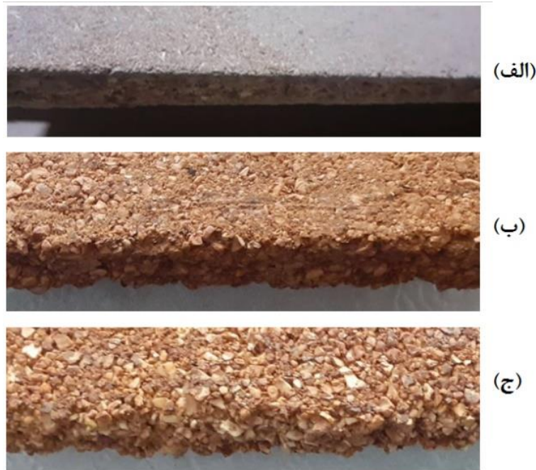
شکل ۸. لبه برش شده (الف) نئوپان ساده (ب) نئوپان چوب گردو (ج) نئوپان چوب گردو / پسته
