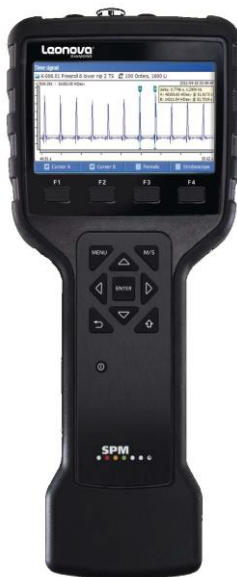
شکل ۳. تحلیل گر ارتعاشی لنوو ساخت شرکت SPM
