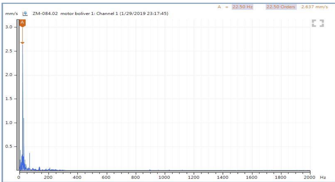
شکل ۱۱. سیگنال دریافتی از بلوئر با میزان ۲۵ گرم نابالانسی
