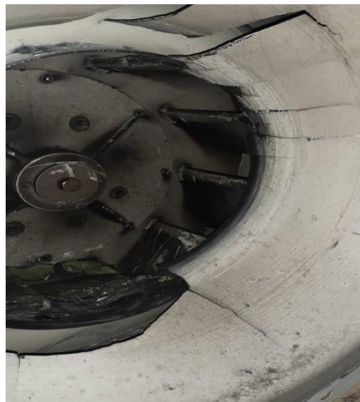
شکل ۲. نمونه‌ای از شکستن پره و حلزونی بلوئرها
