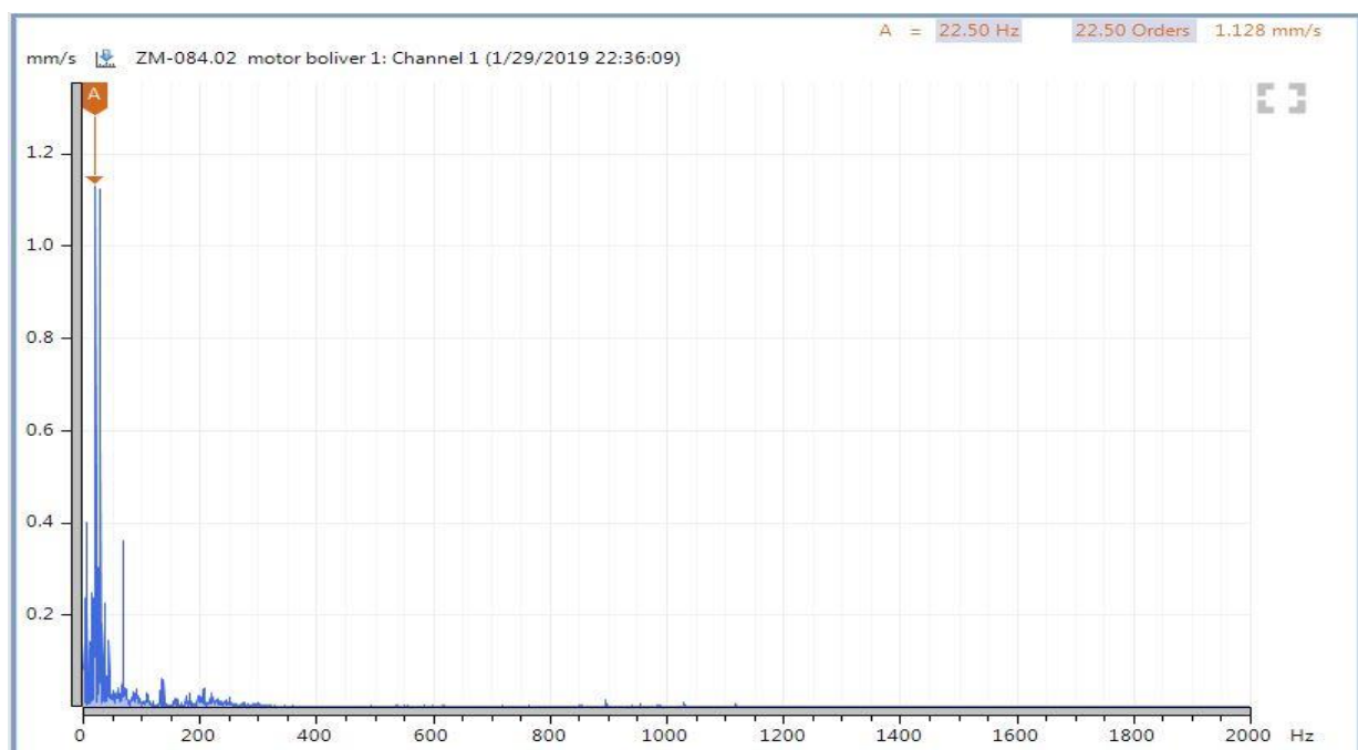
شکل ۵. نمونه‌ای از سیگنال فرکانسی یک بلوئر با شرایط طبیعی
