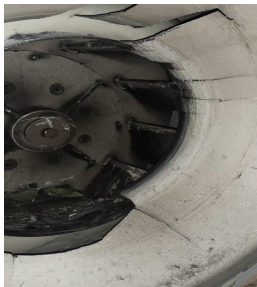
شکل ۲. نمونه‌ای از شکستن پره و حلزونی بلوئرها
