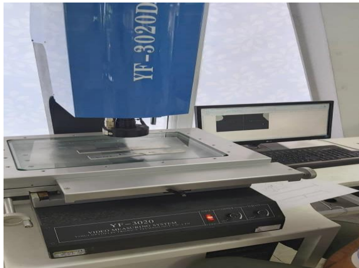
شکل ۷. دستگاه وی‌ام‌ام جهت عکس گرفتن از مقاطع شکست نمونه‌ها.
