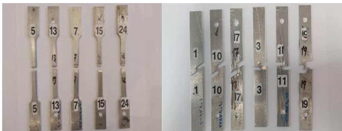
شکل ۴. نمونه‌های برشی و ناچ‌دار پس از انجام تست کشش و شکست ایجاد شده.
