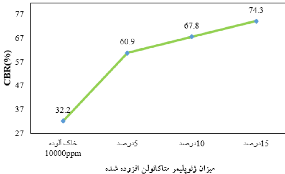
شکل ۱۶. نمودار تغییرات CBR خاک آلوده تثبیت شده در مدت زمان ۷ روز در درصد‌های مختلف ژئوپلیمر متاکائولن
