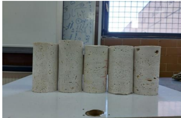
شکل ۴. مغزه‌های آماده شده برای تهیه دیسک
