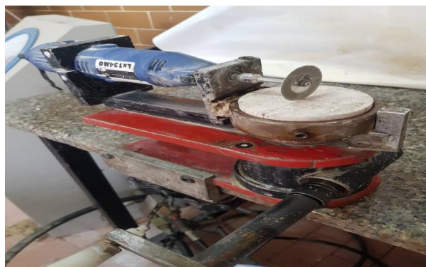
شکل ۵. دستگاه فرز انگشتی برای ایجاد ترک چورون
