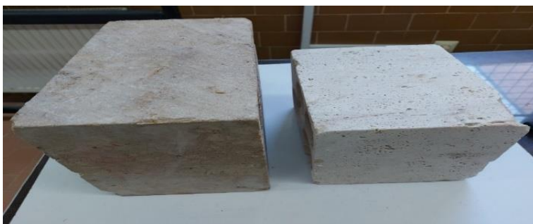
شکل ۱. نمونه‌های سنگ تراورتن (سفید و قهوه‌ای)
