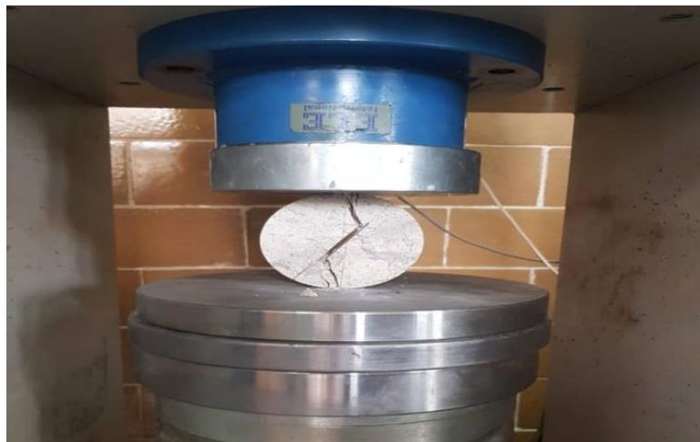
شکل ۸. بارگذاری دیسک‌های برزیلی برای تعیین چقرمگی شکست مود II توسط دستگاه بارگذاری
