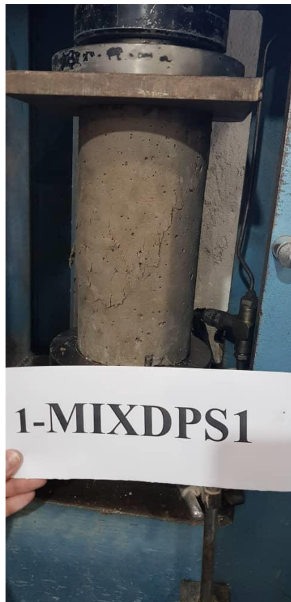
شکل ۲. آزمون مقاومت فشاری تک محوری در نمونه طرح اختلاط اول
