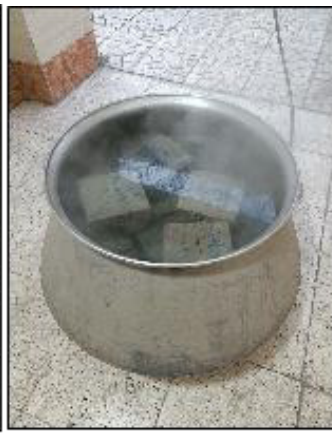
ب (ب) مغروق ساختن نمونه‌ها (b) Drowning samples
