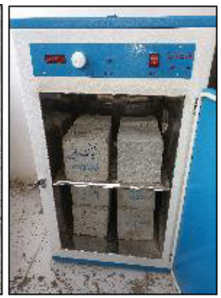
الف (الف) نمونه‌های قرار گرفته در گرم‌خانه (a) The samples placed in the oven
