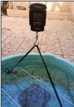
د (د) اندازه‌گیری وزن ظاهری (d) Measurement of apparent weight
