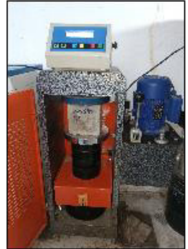
الف (الف) جک بتن شکن (a) concrete breaker jack
