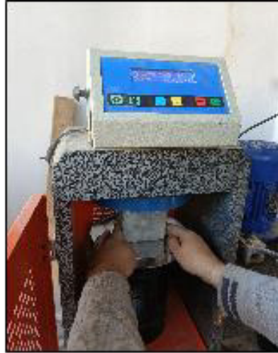
ب نحوه قرار گرفتن نمونه زیر جک (b) How to place the sample under the jack
