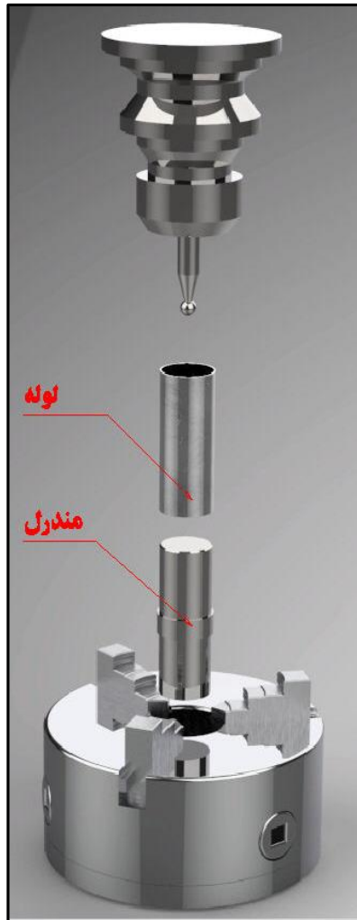
شکل ۴. اجزای ستاپ فرآیند شکل‌دهی
