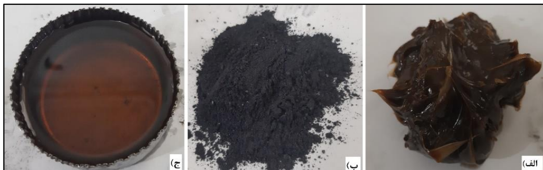
شکل ۲. انواع روانکار (الف) گریس (ب) گرافیت (ج) روغن
