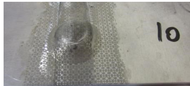
شکل ۶: نمونه شکل داده شده بوسیله آزمون اریکسون با شبکه‌بندی انجام شده در خط جوش
