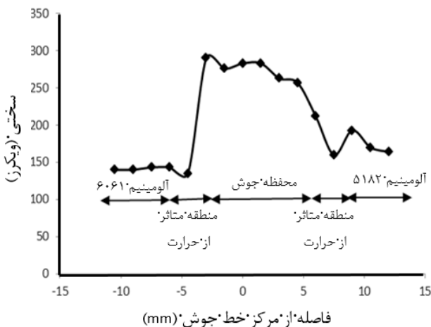
شکل ۸: پروفیل سختی در راستای عمود بر خط جوش
