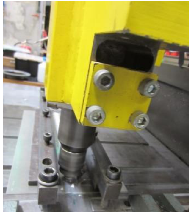
شکل ۲: دستگاه جوشکاری اصطکاکی مورد استفاده در آزمایش های تجربی
