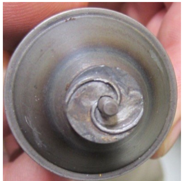
شکل ۴: هندسه ابزار مارپیچ مورد استفاده برای جوشکاری
