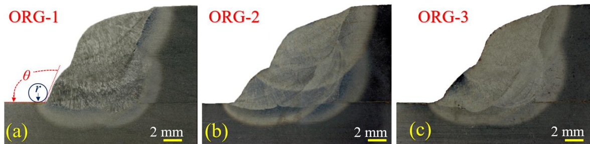
شکل ۸. تصاویر ماکروگرافی سطح مقطع جوشکاری در نمونه‌های مختلف (ORG-1، ORG-2 و ORG-3)
