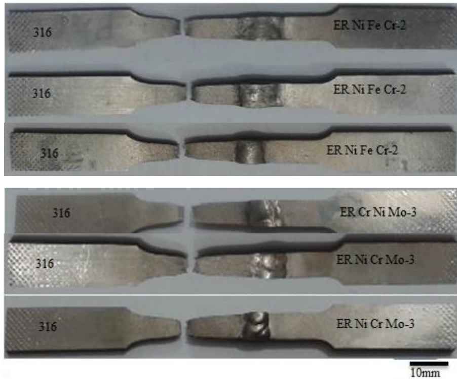
شکل ۱۶. شکست نمونه‌های آزمایش کشش
