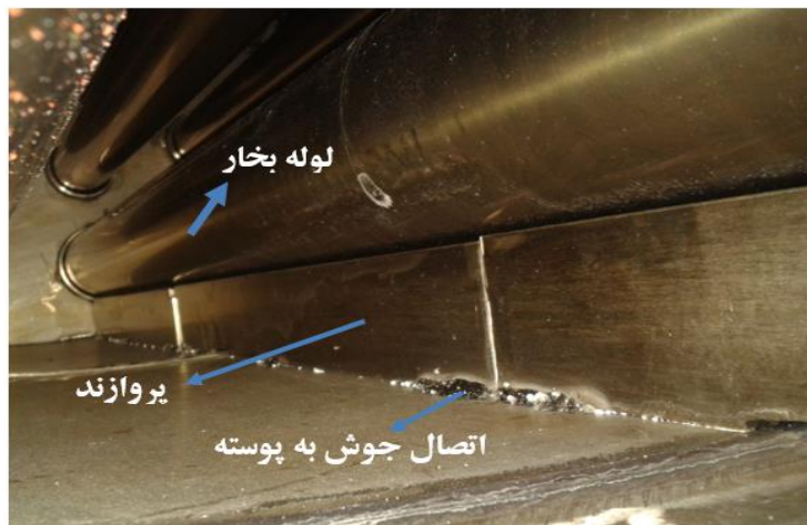
شکل ۴. نمای داخلی خشک کن و نحوه قرارگیری جوش ها و پروازنده
