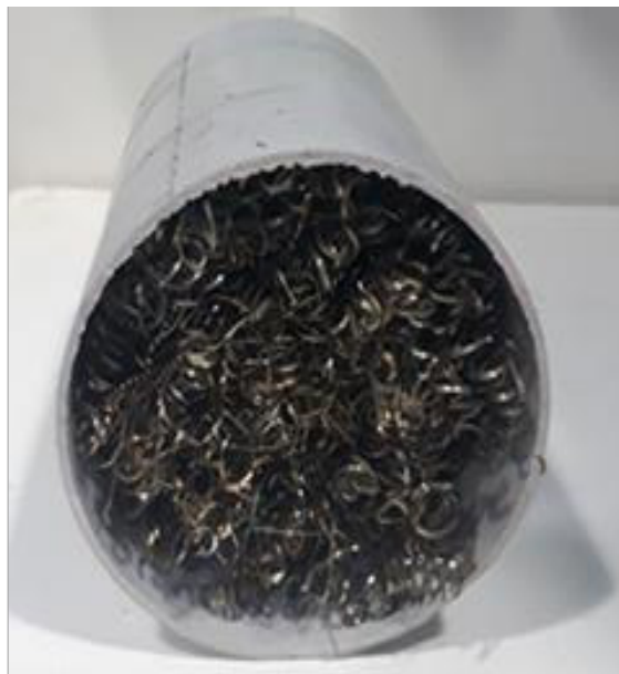
شکل ۴. کلکتور متخلخل مورد آزمایش که از جای دادن الیاف فلزی در یک لوله پلاستیکی ایجاد شده است.
