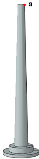
شکل ۱. نقطه انتخابی برای سنجش جابه‌جایی بالای برج آبگیر
