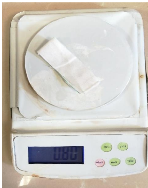
شکل ۵. نمونه پارچه هنگام وزن کشی
