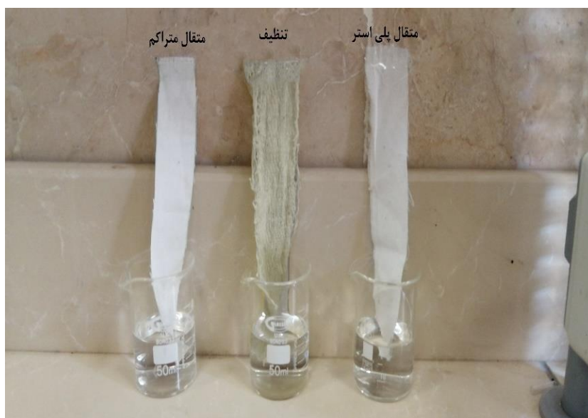
شکل ۶. نمونه پارچه‌ها هنگام آزمایش جذب آب
