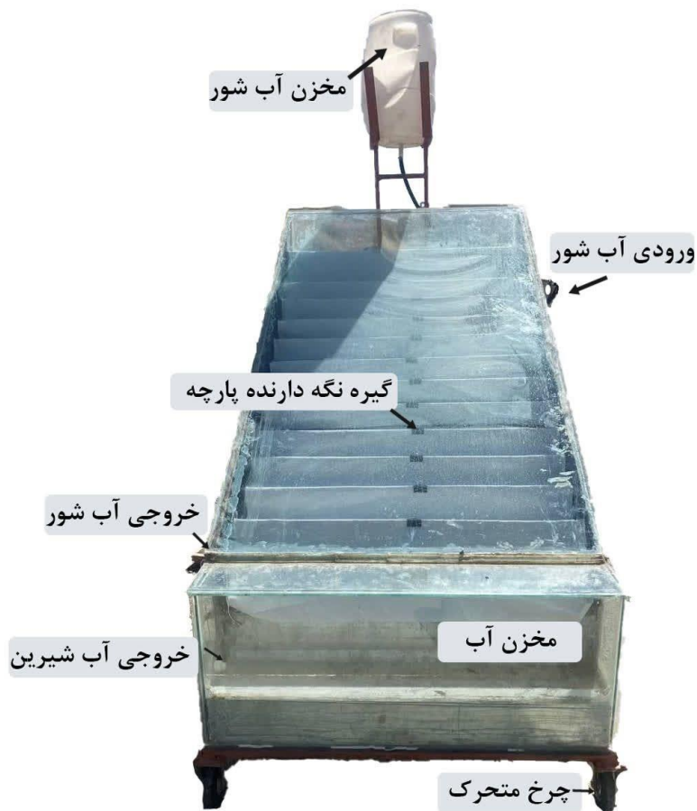
شکل ۲. تصویری از دستگاه آب شیرین کن خورشیدی ساخته شده
