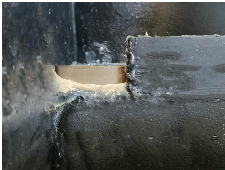
شکل ۱۰. تصویری از سرریز آب به ارتفاع ۱ سانتی‌متر بر روی یک پله از دستگاه
