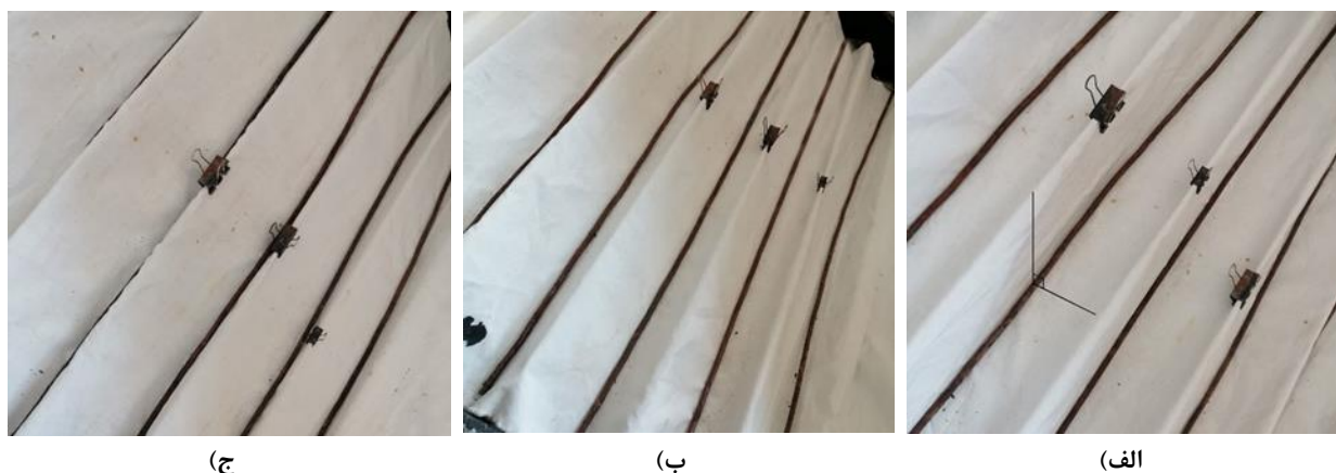
شکل ۹. تصویر نحوه قرارگیری پارچه بر روی پله‌ها به ترتیب در زوایای الف) ۹۰ درجه، ب) ۶۰ درجه و ج) ۳۰ درجه
