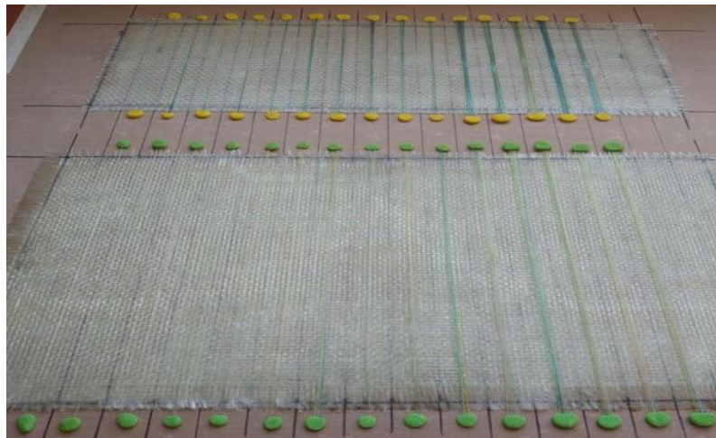
شکل ۲. لایه‌چینی و قرارگیری میکرولوله‌ها بین لایه‌ها و تثبیت آنها
