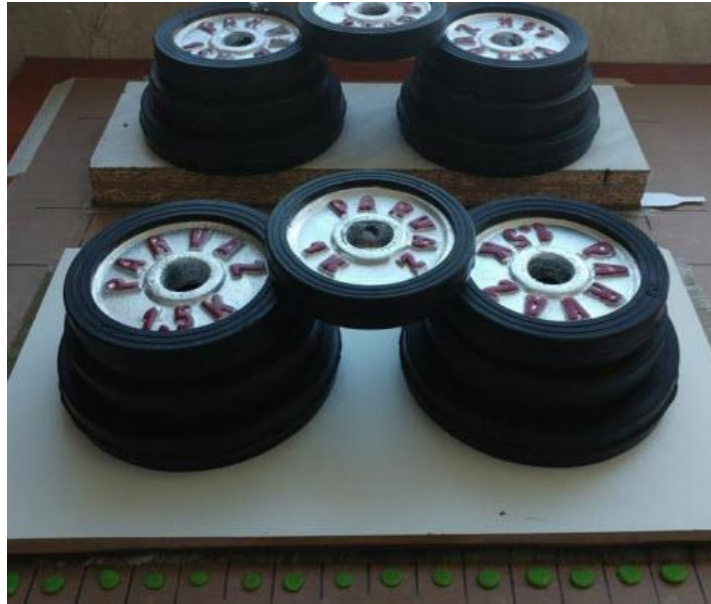
شکل ۳. اعمال فشار بر پنل‌های کامپوزیتی ساخته شده
