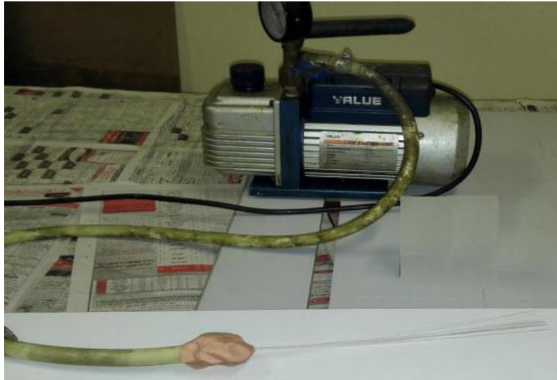
شکل ۱. پمپ خلا و مجموعه مورد نیاز جهت پر کردن میکرولوله‌ها
