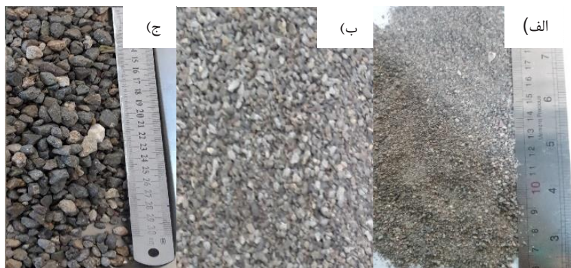
شکل ۲. مصالح مورداستفاده (الف-ماسه ب-شن ریز ج-شن درشت)
