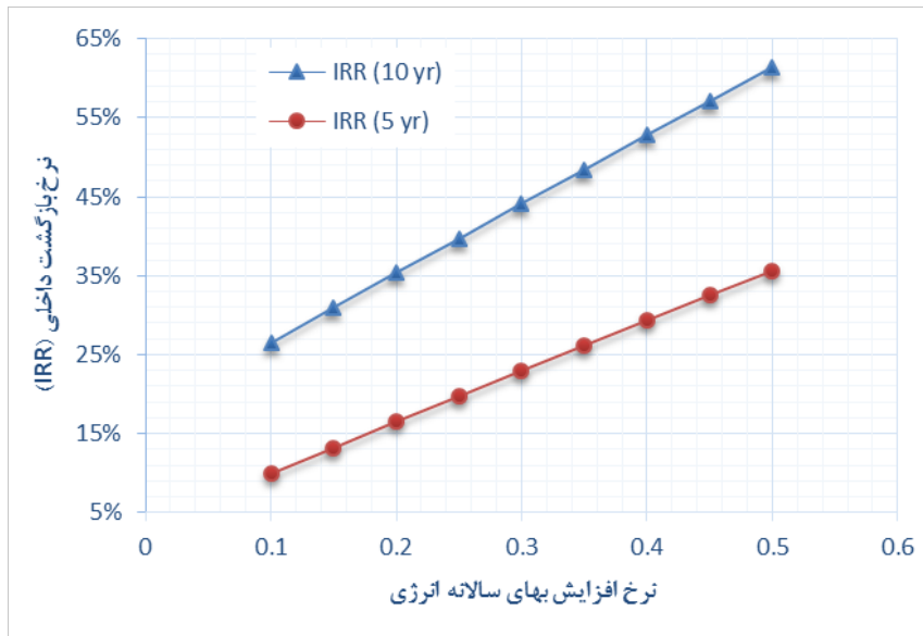
شکل ۱۴. تغییرات نرخ بازگشت داخلی با نرخ افزایش بهای انرژی برای هواساز با ۱۰۰٪ هوای تازه، ۱۲۰۰ ساعت کارکرد سالانه از دیدگاه حاکمیتی
