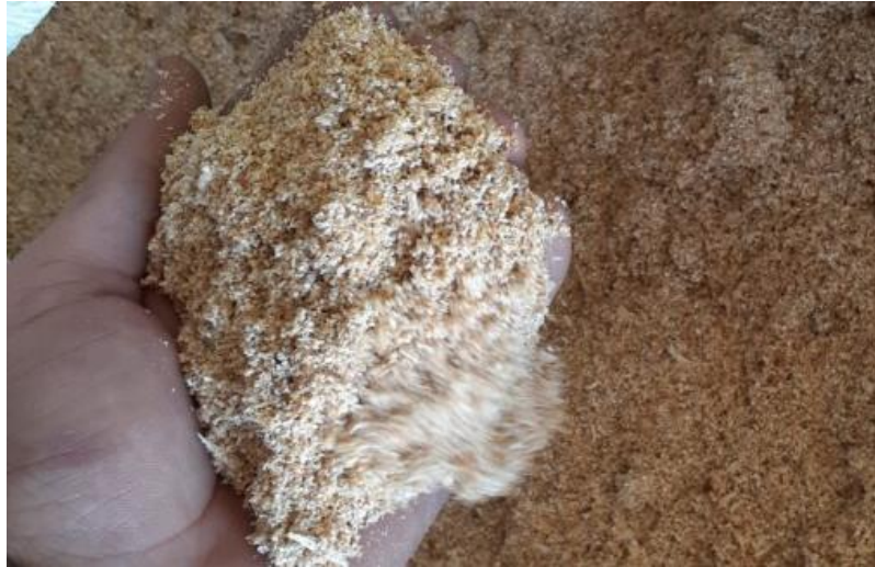
شکل ۵. خاک اره مصرفی در فیلتر زهکش
