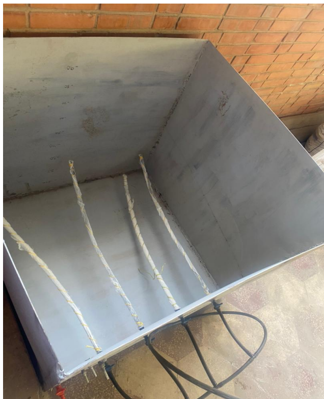
شکل ۹. جایگذاری لوله های زهکش در سیستم فیلتر در تحقیق حاضر
