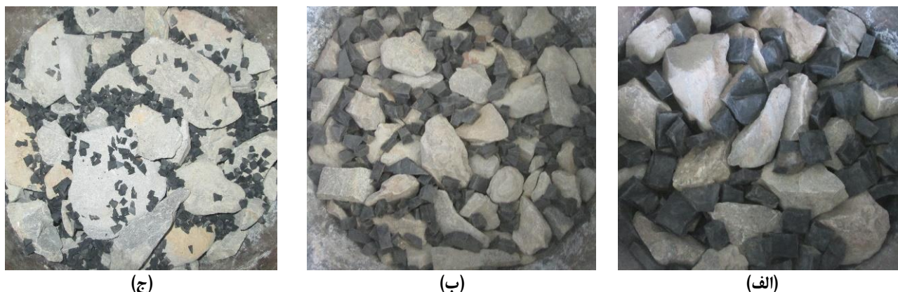
شکل ۱. اندازه‌های مختلف ذرات خرد شده لاستیک ترکیب شده با سنگ‌دانه‌های بالاست، (الف) اندازه ذرات: ۲۵-۱۲/۵ میلی‌متر، (ب) اندازه ذرات: ۹/۵-۴/۷۵ میلی‌متر، (ج) اندازه ذرات: ۲-۴/۷۵ میلی‌متر
