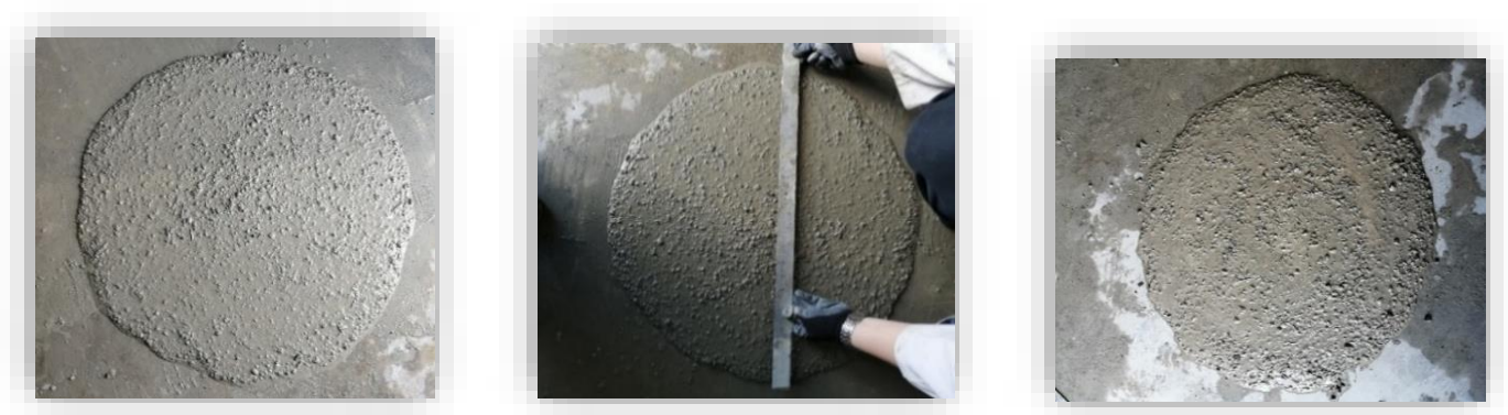
شکل ۶. نمونه ای از تصاویر آزمایش اسلامپ
