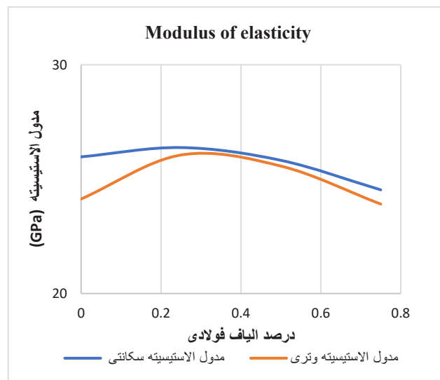
شکل ۲۷. منحنی مدول الاستیسیته طرح های دارای الیاف فولادی
