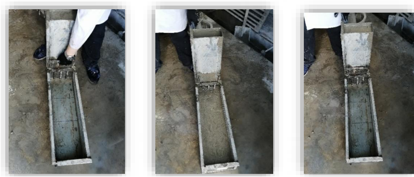
شکل ۱۲. نمونه ای از تصاویر آزمایش جعبه L
