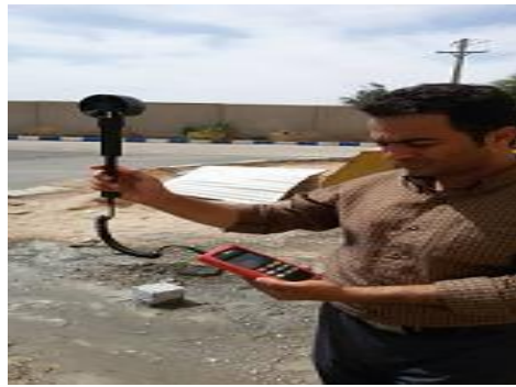
شکل ۶. - بررسی سرعت باد و دما برای ایجاد شرایط تقریباً یکسان ساخت بتن خودتراکم
