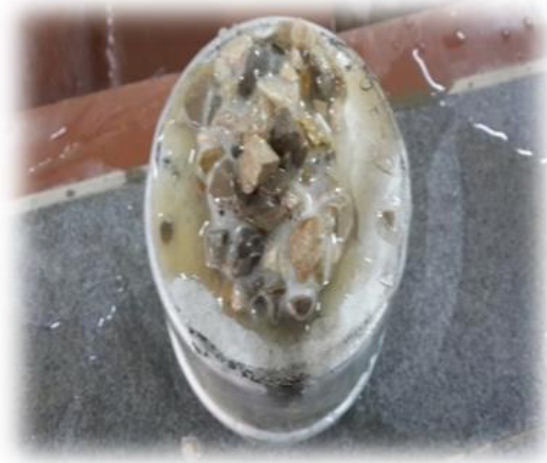
شکل ۱. الف: تأثیر اسید کلریدریک ۱/۰+ نرمال بر روی سنگدانه‌های درشت (شن)
