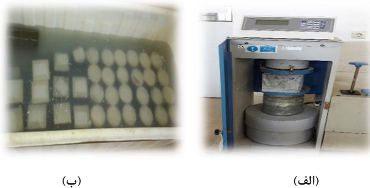
شکل ۷. الف- آزمایش مقاومت فشاری، ب- عمل آوری نمونه‌ها
