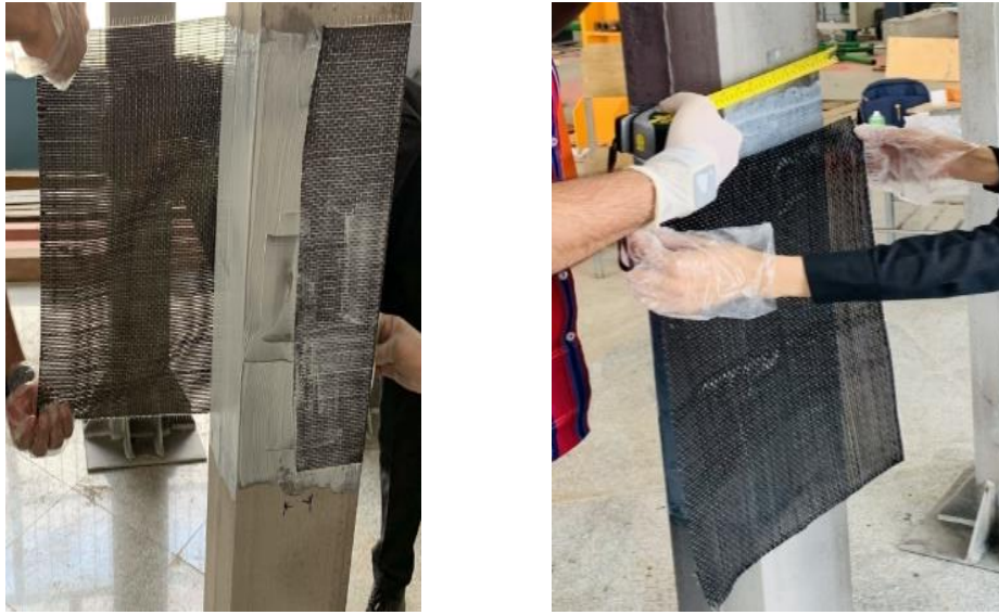
شکل ۷. چسباندن الیاف CFRP به نمونه
