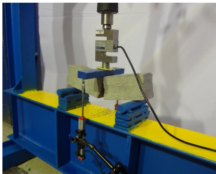
شکل ۵. نحوه انجام آزمایش خمش سه نقطه‌ای.
