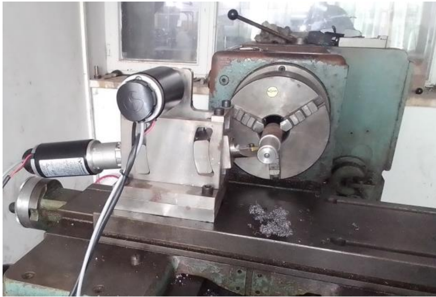
شکل ۶. مکانیزم ابزارگیر نصب شده روی دستگاه تراش TN40
