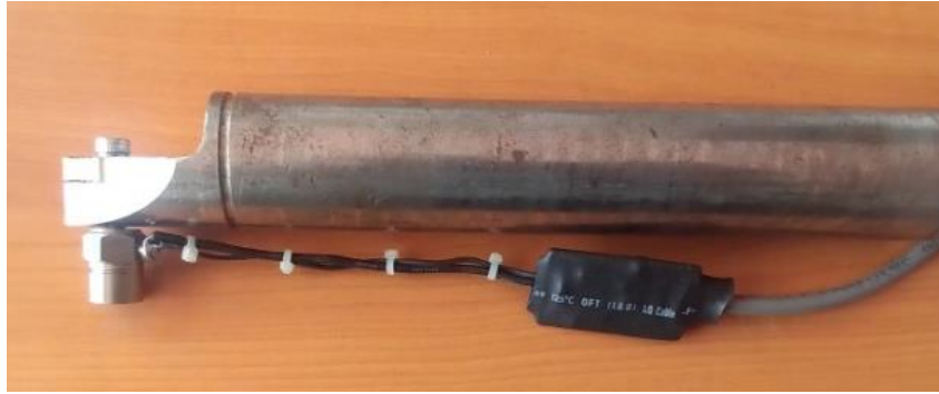
شکل ۹. محل نصب حسگر شتاب‌سنج روی نگهدارنده ابزار
