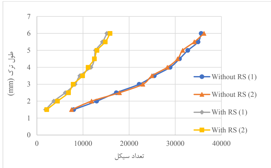
شکل ۱۲. نمودار تجربی رشد طول ترک بر حسب تعداد سیکل برای ۲ نمونه با تنش پسماند و ۲ نمونه بدون تنش پسماند.
