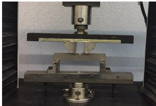
شکل ۲. تنظیمات انجام شده برای انجام تست خمش چهار نقطه.
