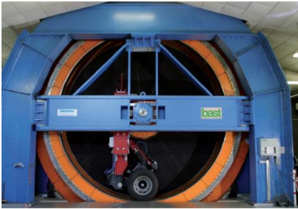
ساختار استوانه دوار داخلی روش استوانه آزمایشگاهی [۶۹]
