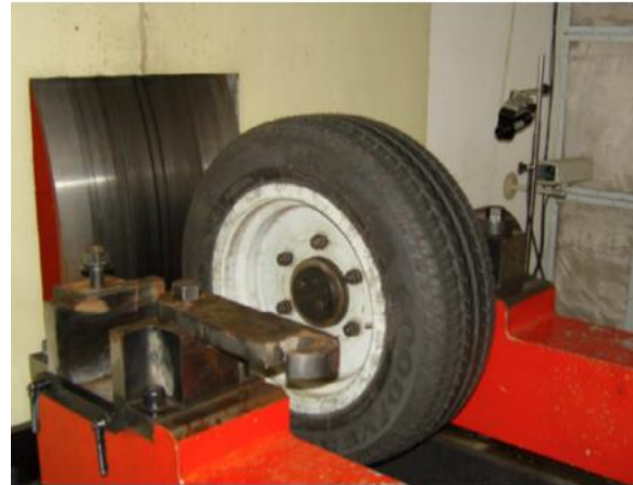
ساختار استوانه دوار خارجی روش استوانه آزمایشگاهی [۶۸]
