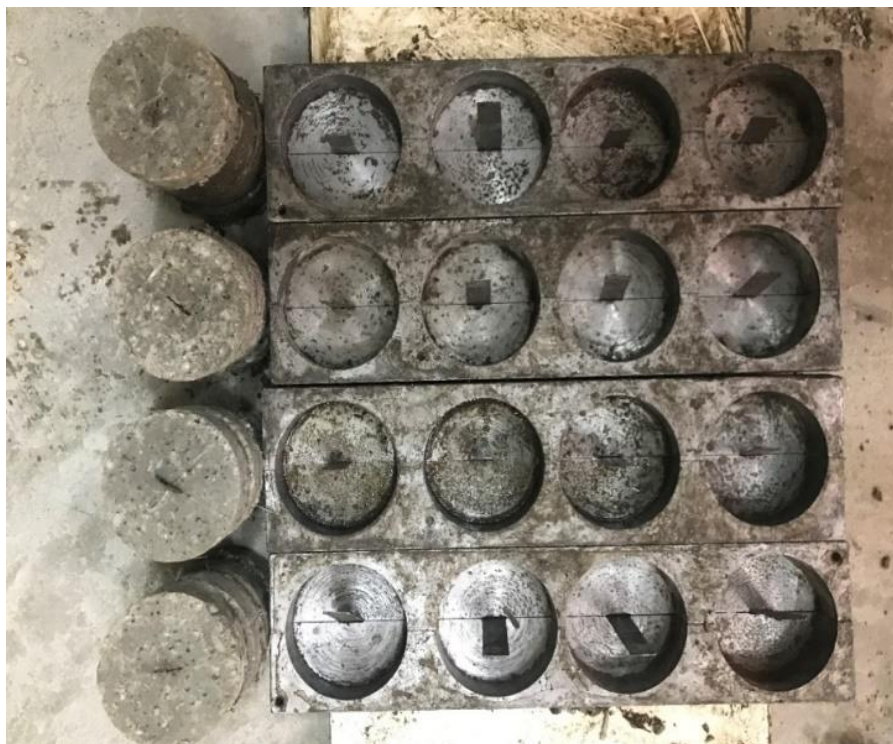
شکل ۱. قالب‌های مخصوص ساخته شده با طرح دیسک برزیلی دارای ترک مستقیم
