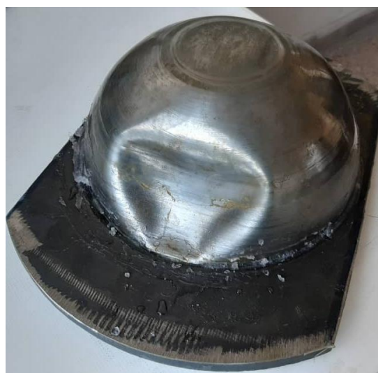
شکل ۲. شکل نهایی نمونه پس از فروریزش
