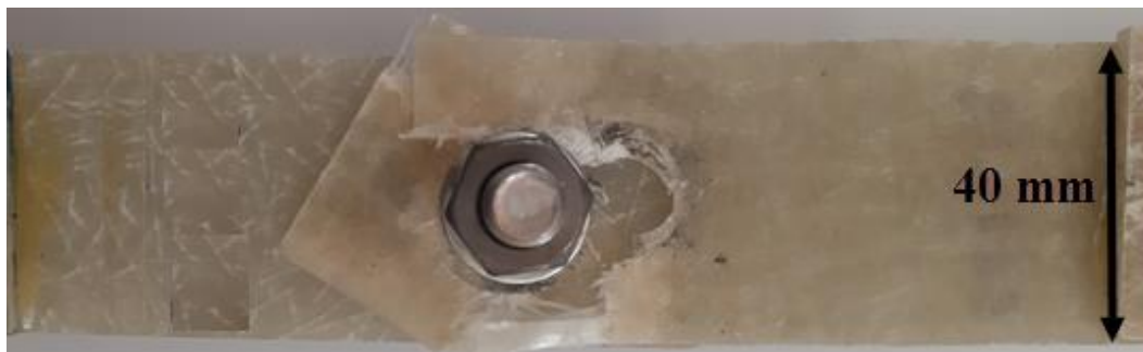
شکل ۷. اتصال با گشتاور سفت کنندگی ۲ نیوتن بر متر پس از انجام آزمایش
