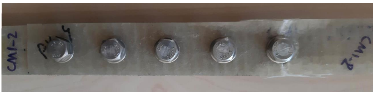
شکل ۱۲. وضعیت قطعه بعد از شکست اتصال با پنج پیچ M8
