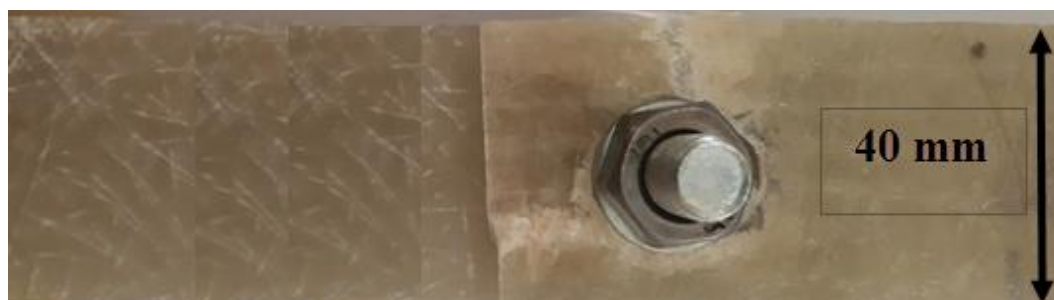
شکل ۸. اتصال با گشتاور سفت کنندگی ۳۰ نیوتن بر متر پس از انجام آزمایش
