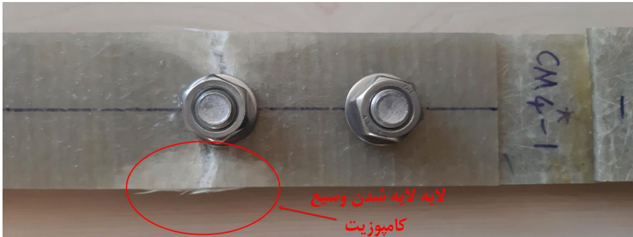
شکل ۱۱. وضعیت قطعه بعد از شکست اتصال با دو پیچ M16
