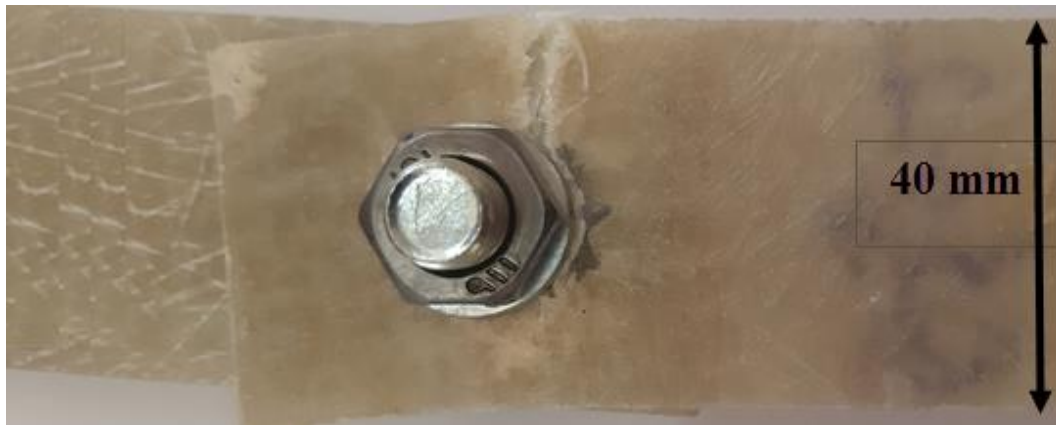
شکل ۹. اتصال با گشتاور سفت‌کنندگی ۵۰ نیوتن بر متر پس از انجام آزمایش
