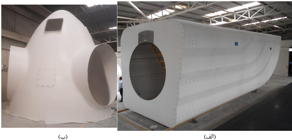
شکل ۱. الف) پوسته ناسل، ب) دماغه توربین بادی دو مگاواتی ساخته شده از قطعات کامپوزیتی
