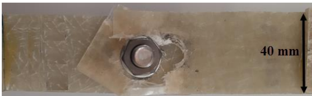
شکل ۷. اتصال با گشتاور سفت‌کنندگی ۲ نیوتن بر متر پس از انجام آزمایش
