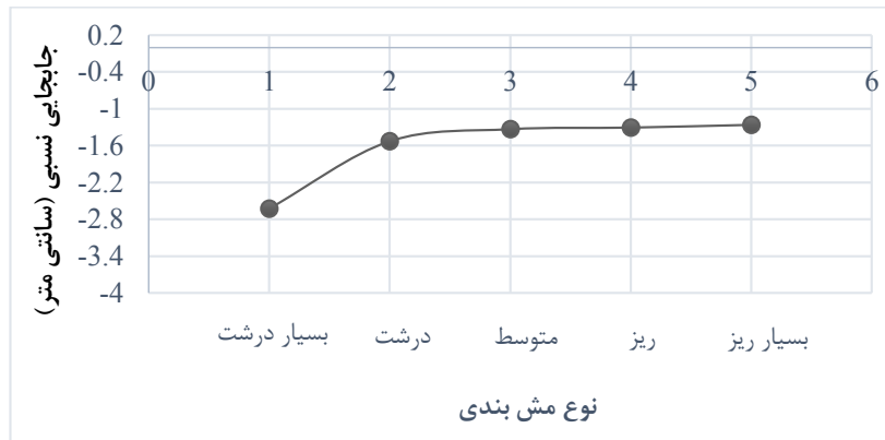
شکل ۷. نتایج همگرایی آزمون حساسیت به اندازه مش در مدل سازی اجزای محدود تحقیق حاضر.
