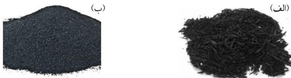
شکل ۱. (الف) الیاف لاستیک؛ (ب) خرده لاستیک
