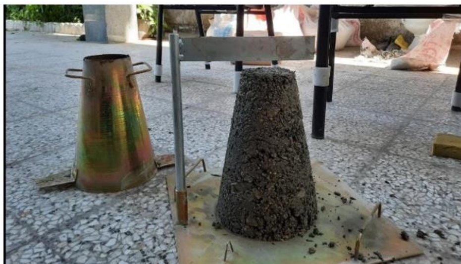
شکل ۲. نمونه اسلامپ بتن لاستیکی
