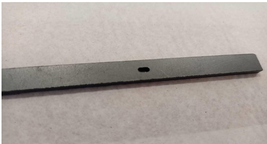
شکل ۳. نمونه های تست خمش تیر سوراخدار
