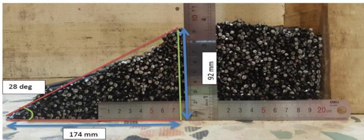
شکل ۳. آزمون زاویه قرار ۱ میله‌های فلزی
