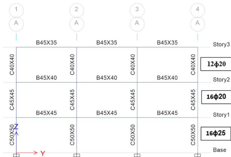
شکل ۲. مقاطع تیر و ستون‌ها و آرماتورگذاری ستون‌ها در قاب معمولی
