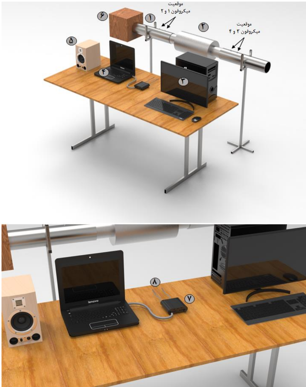
شکل ۱۰. بستر تجربی (۱- لوله امپدانس ۲- مافلر ۳- کامپیوتر (شامل کارت صدا و نرم افزار متلب) ۴- لپتاپ و کارت داده شرکت برول و کیار ۵- آمپلی فایر ۶- بلندگو تمام دامنه ۷- پردازنده اطلاعات ۳۵۶۰ شرکت برول و کیار ۸- میکروفون ۴۹۳۵ شرکت برول و کیار)
