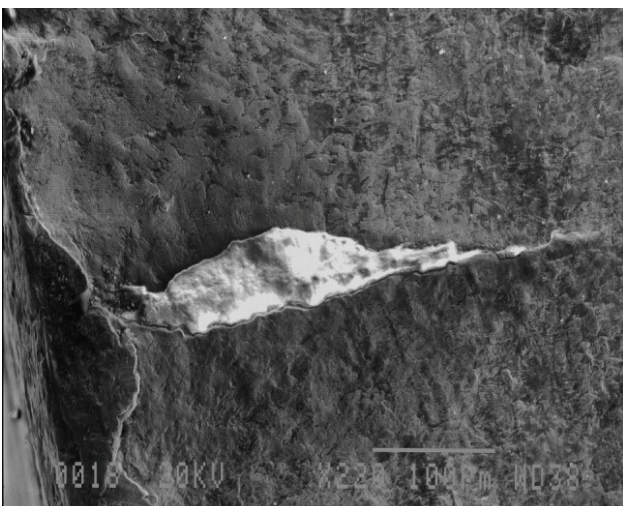
شکل ۱۸: تصویر SEM از نقطه شروع دوم مقطع شکست، تصویر نزدیک تر از ترک بزرگتر
