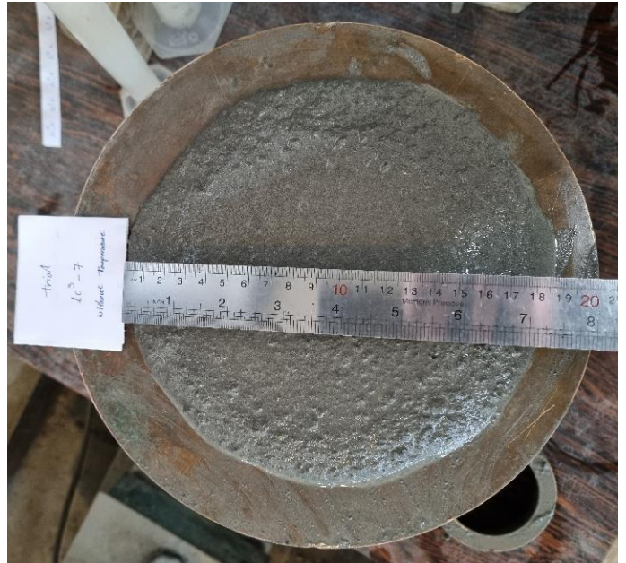
شکل ۷. آزمایش اسلامپ ملات تازه
