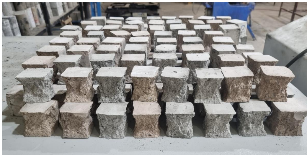
شکل ۱۰. شکست نمونه‌های ملات تحت آزمایش فشاری
