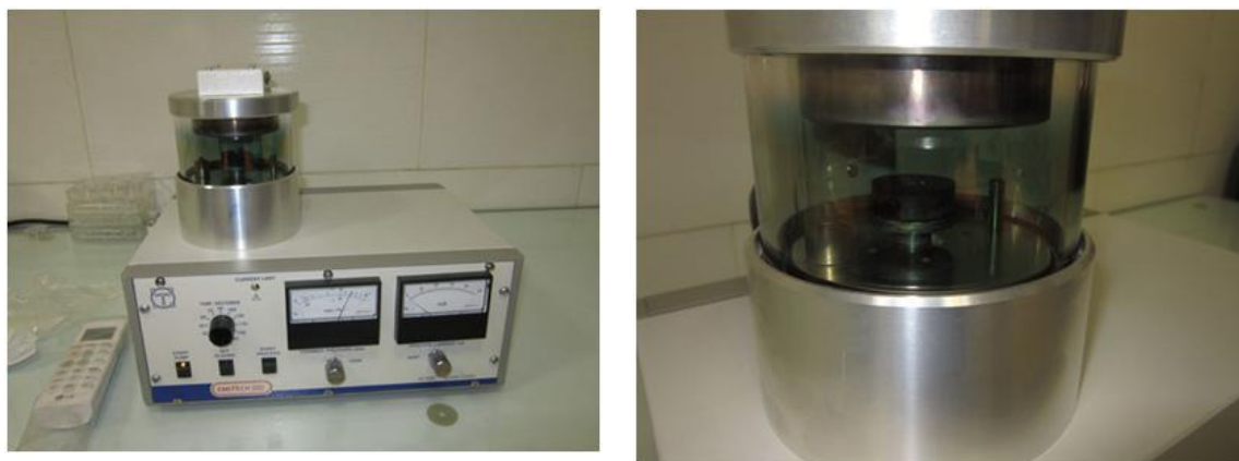
شکل ۹. دستگاه SC7620 (mini sputter coater) و نمونه مانت شده و قرار گرفته در خلا
