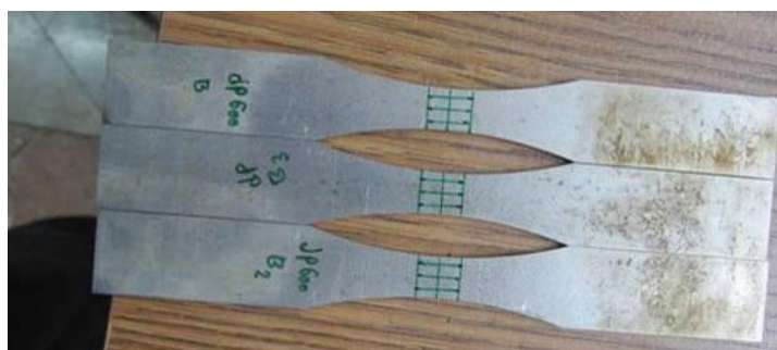
شکل ۷. سه قطعه استاندارد ASTM E 466-82 از فولاد DOCOL 600 DP تهیه شده توسط وایر کات در جهت رول ورق
