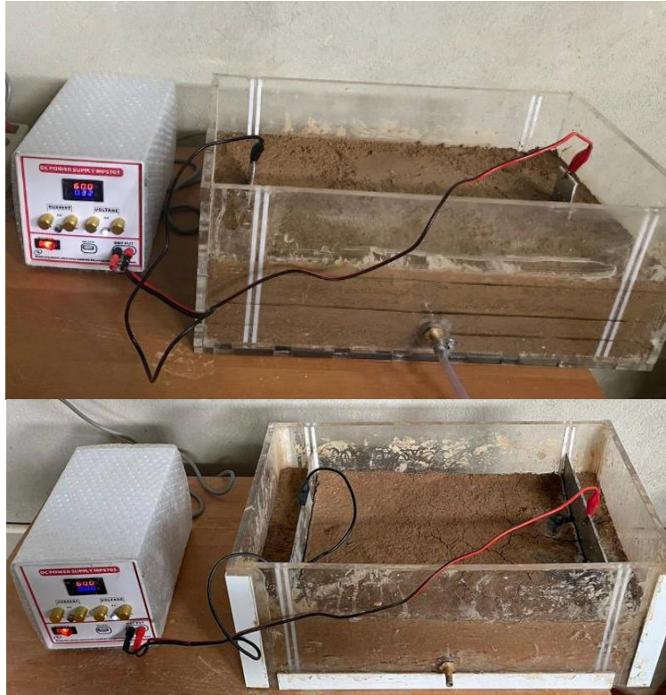
شکل ۴. تصاویری از سیستم الکترواسمزی مورد استفاده در آزمایش در دو حالت استفاده از الکترود میله‌ای و صفحه‌ای
