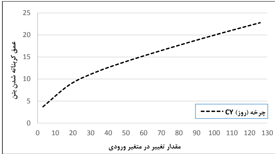
شکل ۷. تحلیل حساسیت بر روی متغیر ورودی چرخه (روز) (CY)
