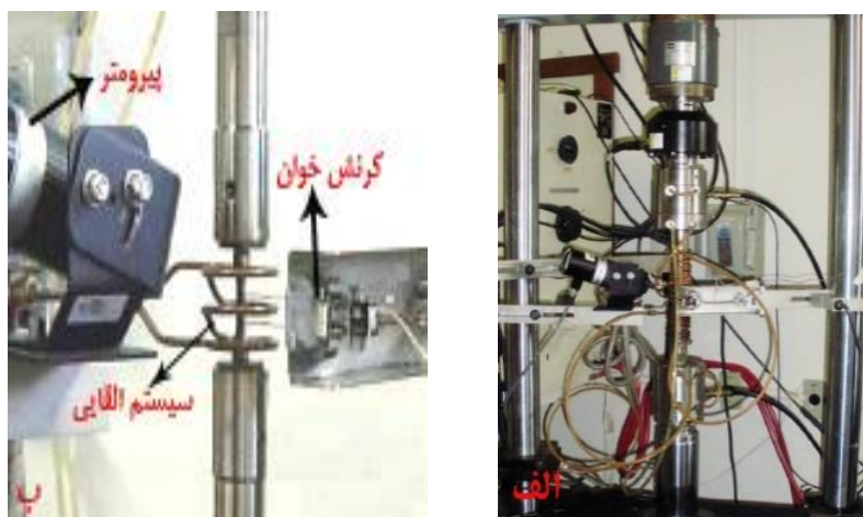
شکل ۳. الف- دستگاه تست خستگی و ب- پیرومتر، سیستم القایی و کرنش خوان
