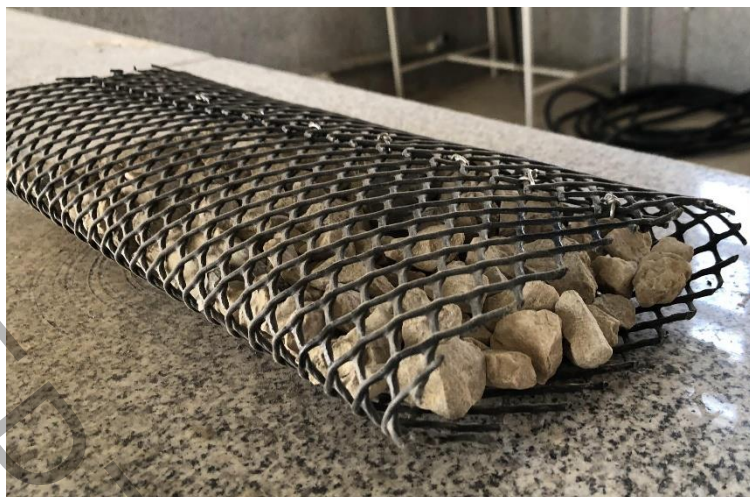
ب): شکل کپسول ساخته شده با مصالح از نمای جانبی
