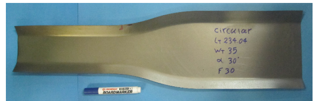
شکل ۱۲: پروفیل‌های تولید شده با منحنی‌های خم دایره‌ای
